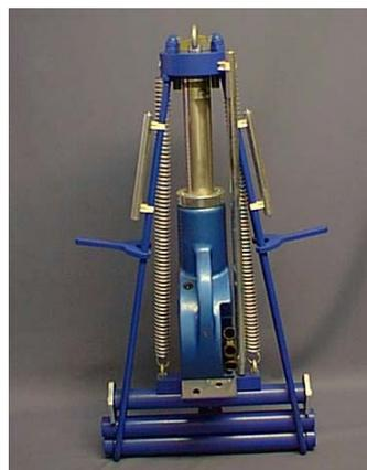
Gli schiacciatiubi per PE permettono di controllare e temporaneamente chiudere il flusso di gas sulle condotte in Polietilene permettendo di effettuare riparazioni e connessioni.
